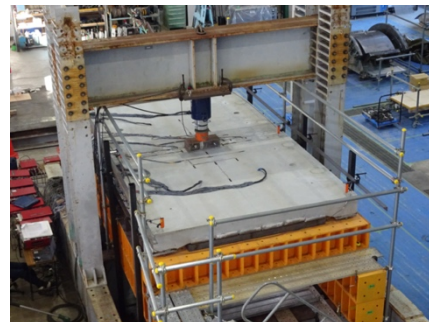
静的押抜きせん断載荷試験
